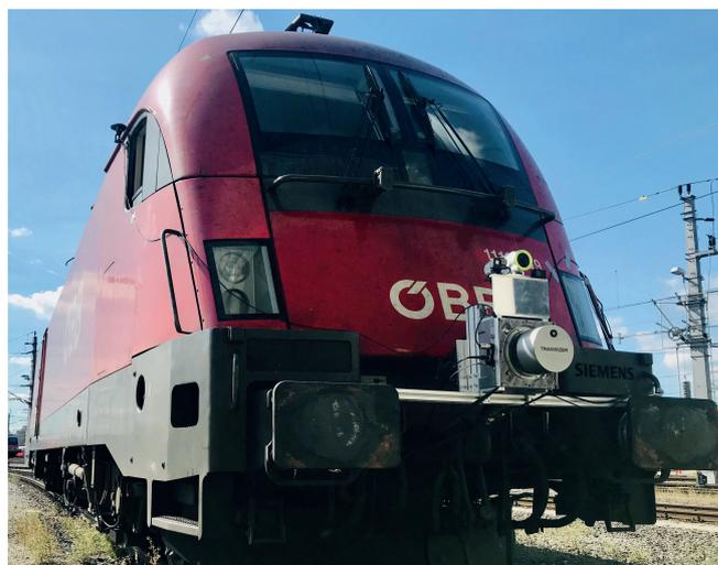
**Bild 2: Aufbau Messequipment**
