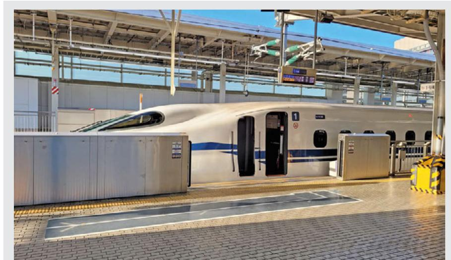
**2:** Stufenlose und schnelle Türen für Kunden an beiden Enden jedes Wagens, dazu eine separate Tür für das Lokpersonal
